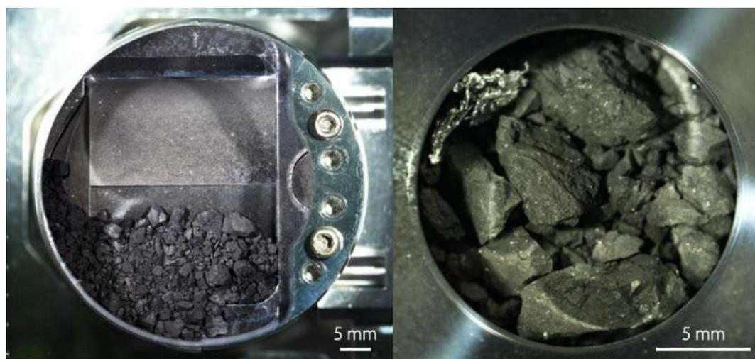
図6 「はやぶさ2」回収サンプル. (左) 格納室A内の第一回着地時採取サンプル. (右) 格納室Cから取り出された第二回着地時採取サンプル.
