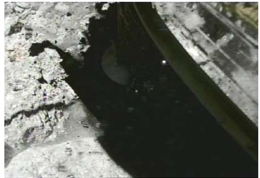
図4 小型カメラCAM-Hが撮影した第一回着地2秒後のリュウグウ表面とサンブラホーン。ホーン下から多数の粒子（探査機の影の中では白っぽく見えている）が飛び出している様子が見える。
