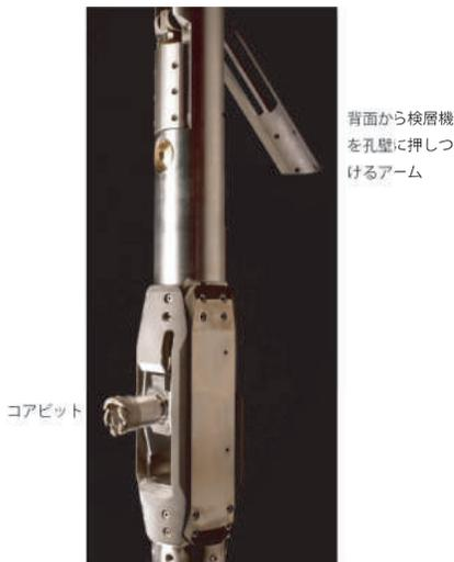
図3 サイドウォールコアリング検層機 (Schlumberger, 2012)。目標深度で検層器を停止させ、コアビットを下方から水平方向へ向きを変えた上で、モーターで高速回転させることで、孔壁からコアを採取する。直径 3.8cm、長さ 6.3cmのコアを最大 50 個取得できる。
