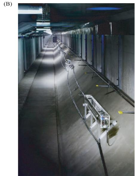
図2 東京湾海底ミュオグラフィセンサーアレイを構成するミュオグラフィセンサーモジュール (A). 素粒子ミュオンを検知する度にダイオードが点灯する. HKMSDDはミュオグラフィセンサーモジュールを一定の間隔に配列した同モジュールの一次元集合体である (B).
