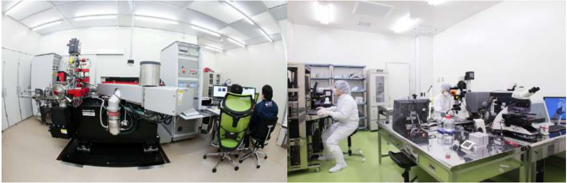
図7 独立行政法人海洋研究開発機構高知コア研究所のクリーンルーム内に整備された超高空間分解能二次イオン質量分析器NanoSIMS 50L (右)とシングルセル分析ラボ(左)。人類の科学資産とも言える希少かつ貴重な試料の微小領域の元素・同位体組成や単一細胞レベルの生命シグナルについて、地球惑星科学と生命科学を融合した最先端分析研究の進展が期待される。
