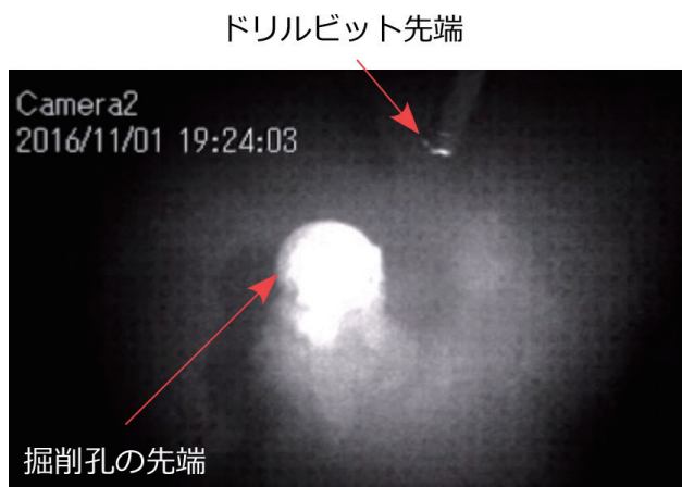
図2：プレート境界近傍の間隙流体が、掘削孔を通して海底面（水深4476 m）の掘削孔先端から噴出している様子（お宝動画： https://www.jamstec.go.jp/j/about/press_release/20210617/#m1 ）
