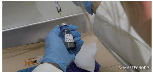
図1：室戸岬沖限界生命圏掘削調査 (IODP 第370次研究航海) において、「ちきゅう」船上に整備された専用のコンテナラボで行われた放射性トレーサー実験の様子。微量のトレーサー基質を堆積物コア試料が入ったガラス瓶に添加している。
