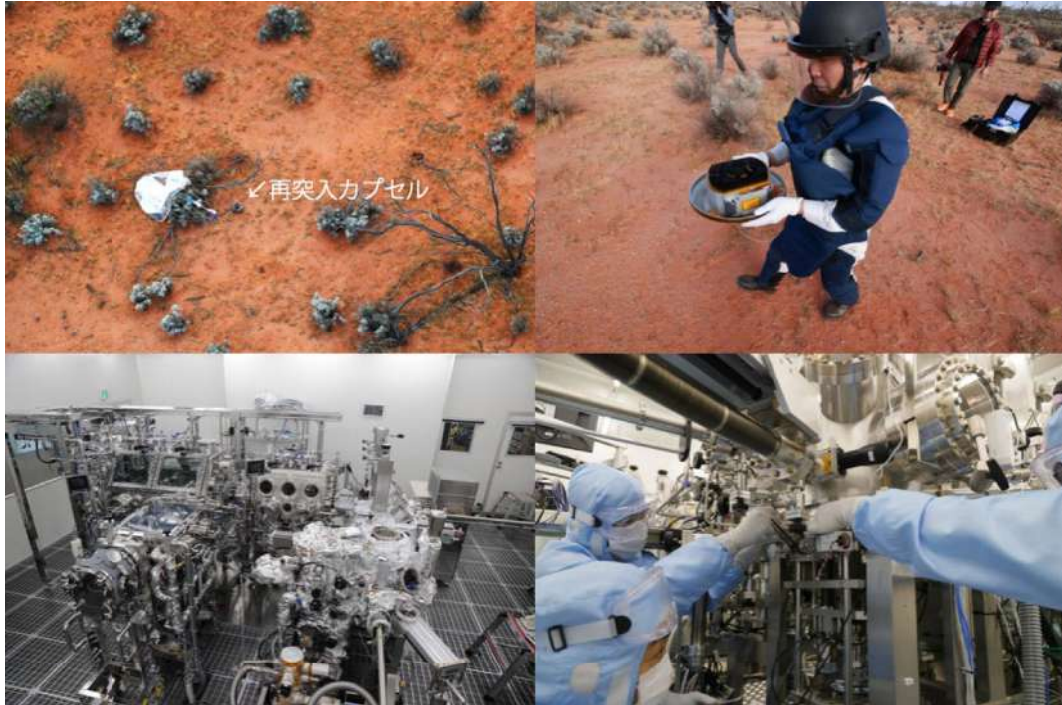
図5 (左上) 地上に着地した再突入カプセル.,(右上) カプセル回収作業.,(左下) JAXA宇宙科学研究所キュレーション施設に設置された「はやぶさ2」粒子専用クリーンチャンバーシステム.,(右下) クリーンチャンバーシステムへのサンプルコンテナの取り付け作業.
