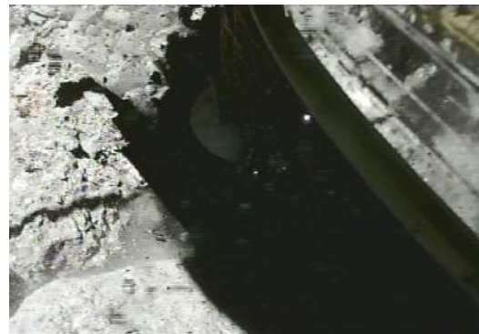
図4 小型カメラCAM-Hが撮影した第一回着地2秒後のリュウグウ表面とサンプルラホーン。ホーン下から多数の粒子（探査機の影の中では白っぽく見えている）が飛び出している様子が見える。
