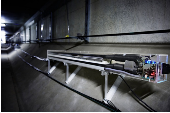
図2 東京湾海底ミュオグラフィセンサーアレイを構成するミュオグラフィセンサーモジュール (A). 素粒子ミュオンを検知する度にダイオードが点灯する. HKMSDDはミュオグラフィセンサーモジュールを一定の間隔に配列した同モジュールの一次元集合体である (B).
