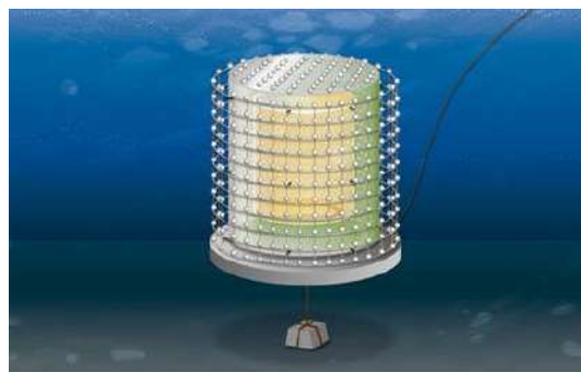
図4 1.5kt OBD検出器の概要図。
