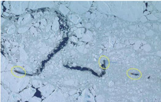
図3 ACEX 北極海掘削航海中の上空よりの砕氷風景：数十枚の衛星画像集積コンポジットによる；黄色丸は左より順に、ソビエツキー・ソユーズ号、オーデン号、ビダール・ピキング号を示す。海水は、図左より右に約0.3ノットの速度で流れている (Moran *et al.*, 2006).
