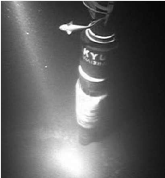
図2 2012年7月7日に設置された温度計を吊り下げるためのウェルヘッド。海底は水深6900メートル。写真提供はJAMSTEC。
