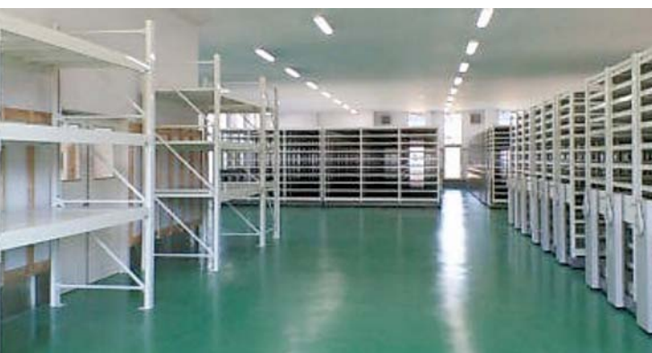
写真1:ボーリングコア試料倉庫内部(完成直後、試料搬入前の状態) 画面右側は手動の移動棚(1m長のコア箱用)。左側は固定棚(定形外の容器入りの試料用)。
