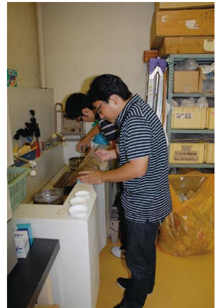
岩相記載用カッタングスの洗浄実習に取り組む受講者
