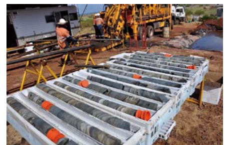
図4. 掘削コアの風景。掘削は浅い柔らかい部分はPQサイズのコア、深くなるに従い、HQ、NQのサイズに変更している。
