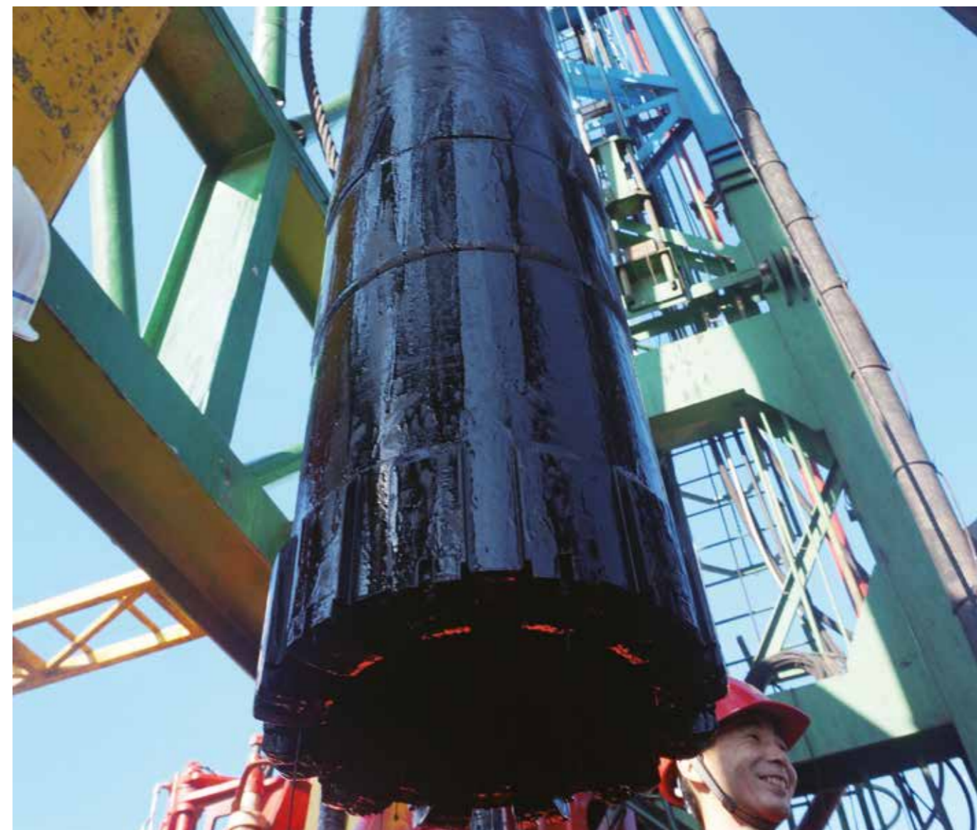
ICDPの白亜紀Songliao盆地掘削プロジェクト(SBDP)は、新設計の掘削装置で深さ7,018 mに到達し、直径が20cm以上もある長さ40 mに達するコア試料を回収した。このコア試料は白亜紀全体にわたる気候や環境の変遷の解明を可能にする。
