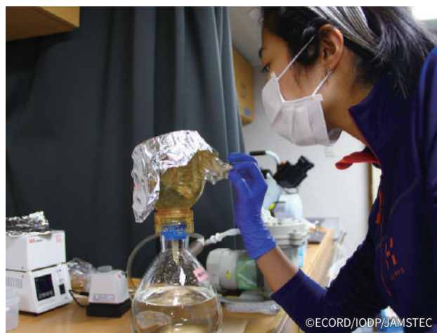
直上海水のフィルター濾過作業の様子
