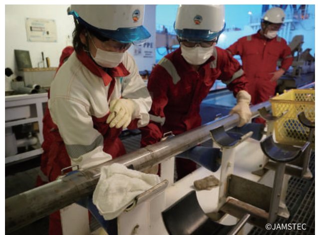
写真2：Core Cutting Area でのコア切断作業の様子
