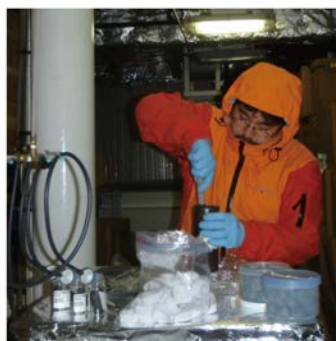
図2：（左）培養試料の準備作業、掘削船の最下層にある冷蔵室で実施。（右）密閉できるガラス容器にコア試料を入れ、上からエサとなる物質を溶かした溶液を浸み込ませて培養した。
