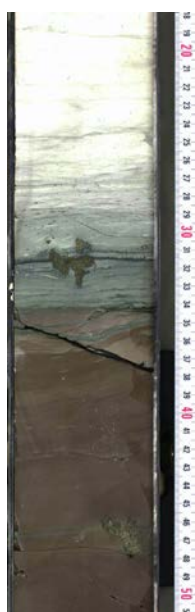
衝突由来の堆積物最上部層および上位の古第三紀石灰岩層における掘削コア試料のスキャン画像。イリジウムが濃集しているのは、暗褐色の細粒な粘土層と灰緑色の石灰岩層の境界部 (Onshore science party of IODP-ICDP Expedition 364 より引用)。
